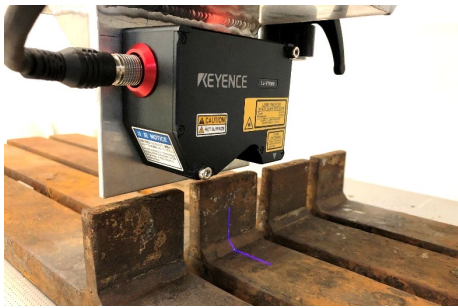
(a) Messung mit dem Laser-Profilsensor
