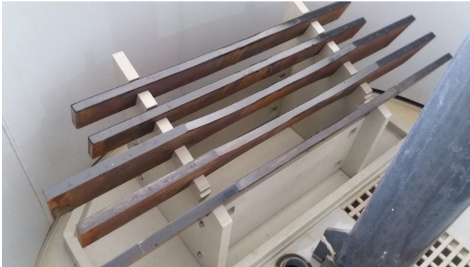
Abbildung 3.5: Exemplarischer Aufbau in der Salzsprühnebelkammer, aus (Ummenhofer et al., 2018)
