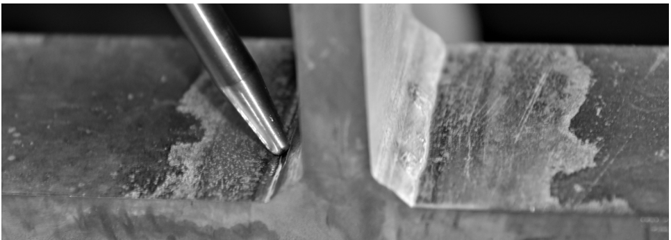
Abbildung 1.1: HFH-Anwendung zur Nachbehandlung eines ermüdungskritischen Schweißnahtübergangs
