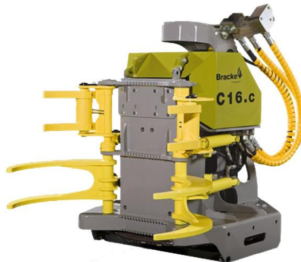
Abb. 4.1 Fäll-Bündler-Aggregat mit doppelten Greiferarmpaaren der schwedischen Firma Bracke Forest
