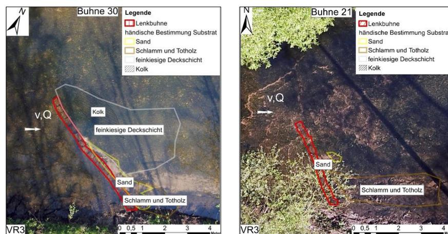
Abbildung 4-11: Vergleich der Substratsortierung an Lenkbuhne 30 (links) und Lenkbuhne 21 (rechts) in VR3 anhand des Luftbilds der Drohnenbefliegung und der händischen Abgrenzung zwischen den Substratflächen per Tachymeter
