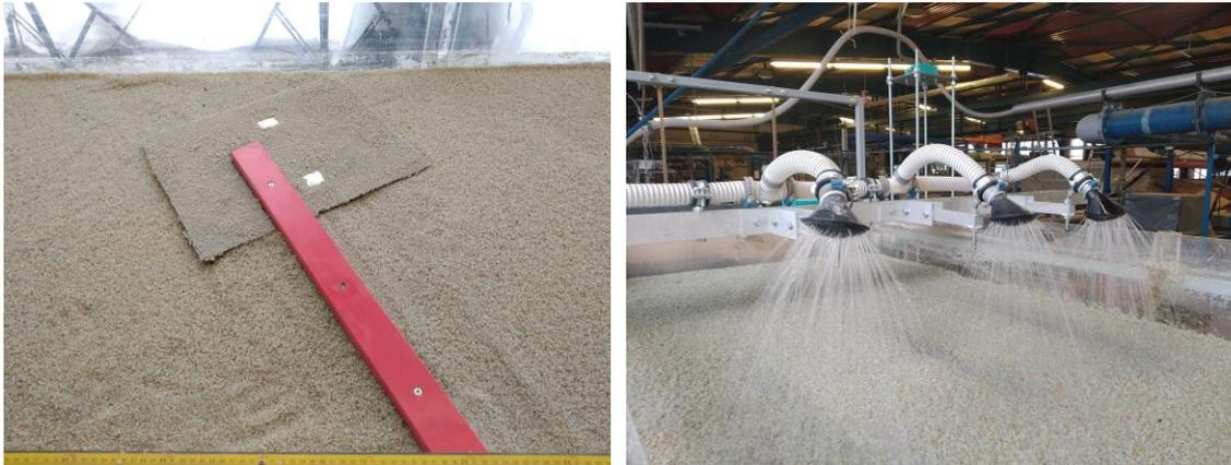
Abbildung 6-4: Schutzplatten aus Metall zur Vermeidung unerwünschter Sedimentumlagerungen während des Befüllvorgangs (links) und Bewässerungsvorrichtung für die morphologischen Versuche (rechts)
