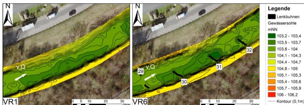
Abbildung 4-17: Entwicklung der Sohlmorphologie in Abschnitt 6 mit langen Lenkbuhnen von VR1 nach VR6
