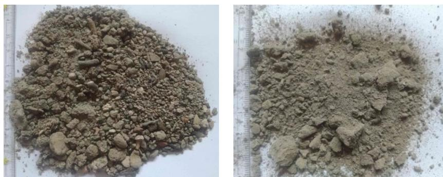
Abbildung 5-26: Sedimentprobe 1 aus dem Kolkbereich in Querprofil 3 unterstrom der ehemaligen Wehranlage (links) und Sedimentprobe 2 aus dem verschlammten Bereich in Querprofil 1 oberstrom der ehemaligen Wehranlage (rechts)
