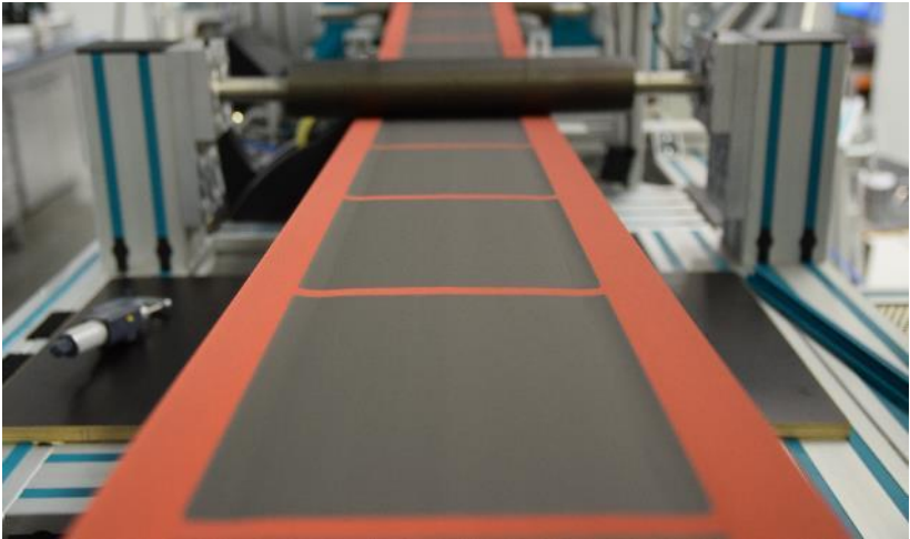
Abbildung 5.20: Intermittierend beschichtete Anode im Rolle-zu-Rolle Verfahren mit 150 mm Beschichtungsbreite.
