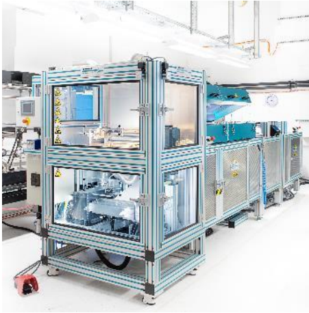
Abbildung 2.8: Verwendete Rolle-zu-Rolle Beschichtungsanlage. Die Beschichtungsanlage mit den einzelnen Modulen werden in der Arbeit von Wengeler im Detail dargestellt und beschrieben. 33
