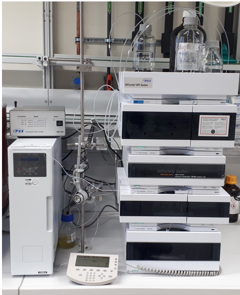
Abbildung 7.2: Experimenteller Aufbau für die FT-SEC. Der Aufbau basierte auf dem der LAC-NMR Kopplung, gezeigt in Abbildung 5.1, S. 42. Zum Starten einer FT-SEC Messung wurde ein universal data center (UDC) mit einem manuellen Injektionsauslöser verwendet. Ein sinusförmiges Chromatogramm wurde vor und eines nach der Säule detektiert, um die Phasenverschiebung zwischen den Chromatogrammen mittels Fourier-Transformation zu bestimmen. Zur Möglichkeit der Durchführung konventioneller SEC Messungen war ein manuelles Injektionsventil vor der Säule installiert. Modifiziert nach Matz et al. 2022.[153]
