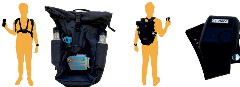
Abbildung 1: Schematische Darstellung des Sensorequipment mit Smartphone, Empatica E4, GoPro-Kamera sowie zum Open-WalkSensor umgebauten OpenBikeSensor.
