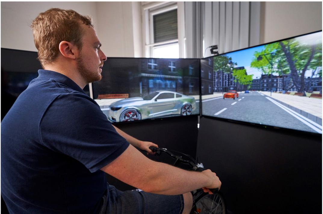
Abbildung 3: VRU-Simulator mit dem Fahrrad im Straßenverkehr
