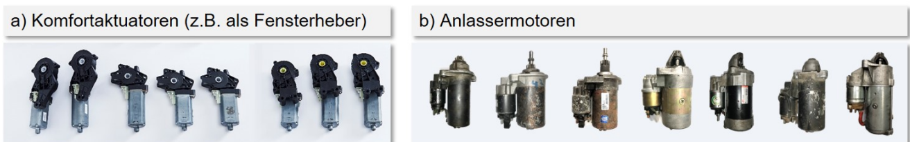
Abbildung 6.2: Produktbeispiele für die in der AgiProbot-Demonstratorfabrik demontierten Elektromotoren: a) Komfortaktuatoren und b) Anlassermotoren
