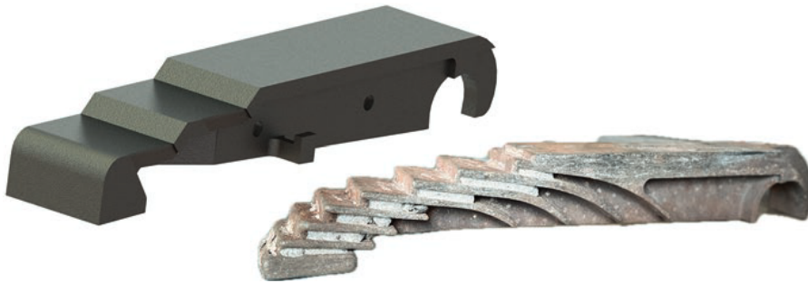
Abb. 9.11 Roststab in der Konstruktionszeichnung (linkes Teilbild) und nach Ablauf der Standzeit in einer Feuerung (rechtes Teilbild) [23]
