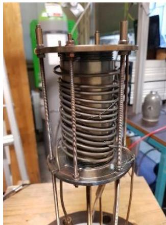
Ionisator mit Heizelement und Schutz-Ni-Band
