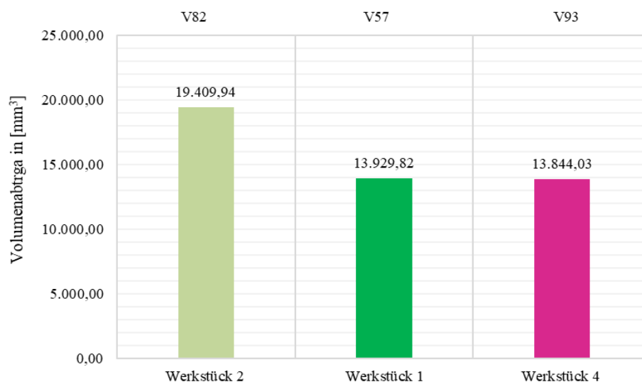
Abbildung B-2.2: Vergleich Volumenabtrag KSB1 (HSS) an Werkstück 2, 1 und 4 bei 100 \text{ min}^{-1} und V_{f4}
