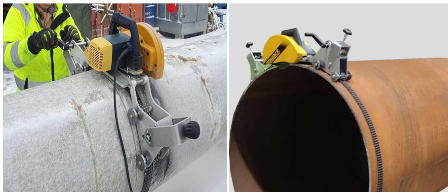
Abbildung 3.4: Kettengeführte Rohrtrennmaschine „Exact Infinity“ [64]
