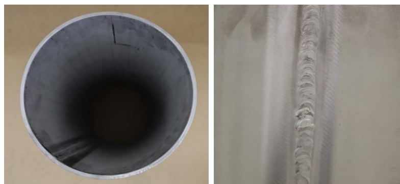
Abbildung 4.9: Draufsicht und Großaufnahme Längsschweißnaht Werkstück 1
