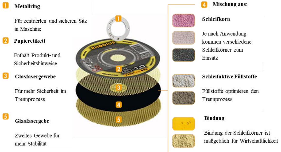
Abbildung 4.5: Aufbau einer Trennscheibe mit konventionellen Schleifmitteln, nach [101, S. 2]
