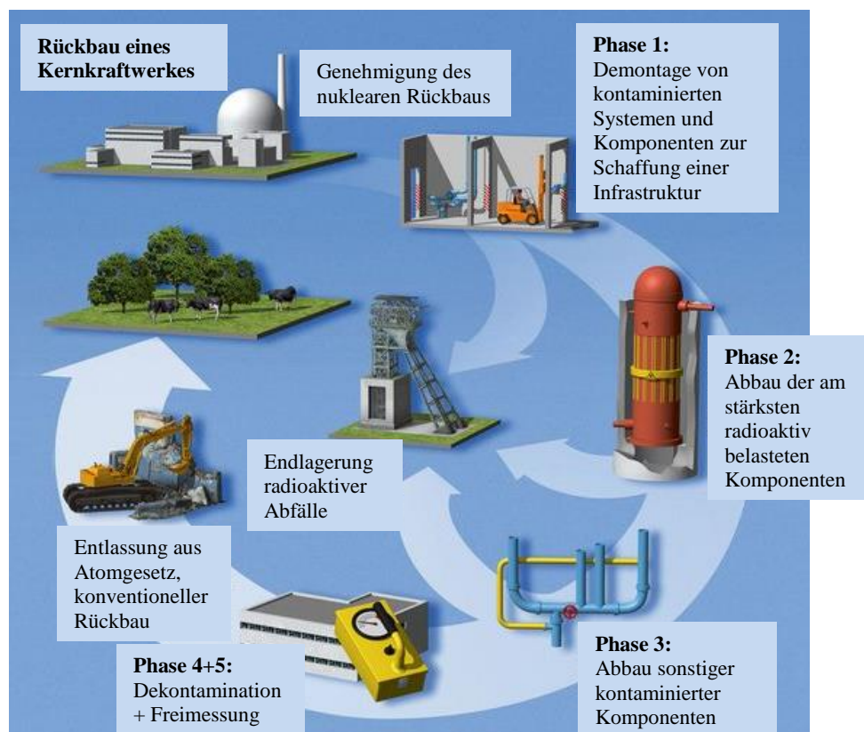
Abbildung 2.1: Ablauf Rückbau eines Kernkraftwerkes, nach [19]
