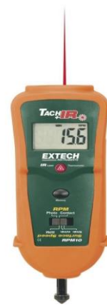
Abbildung 4.19: links: Zuordnung Schalterstellung MOVIMOT Stirnradgetriebemotor zur Abtriebsdrehzahl; rechts: Laser-Fototachometer Modell RPM10 [122]
