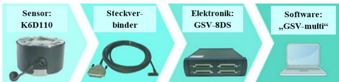
Abbildung 4.22: Datenübertragung 6-Achsen-Kraft-Momentensensor (Typ K6D110), nach [125]
