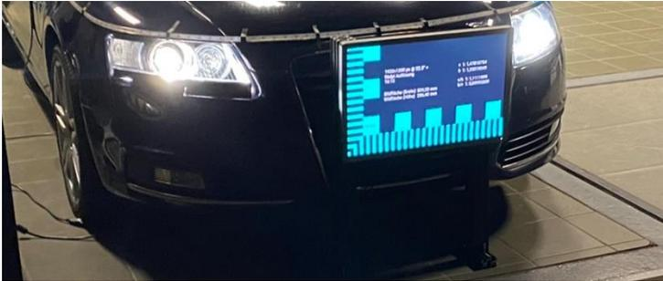
**Abbildung 5.36:** Voruntersuchung mit LCD-Bildschirm zur Darstellungen von Inhalten an der Fahrzeugfront. Bei Dunkelheit ist ein ausreichender Kontrast möglich, bei Tageslicht sind keine Inhalte erkennbar.
