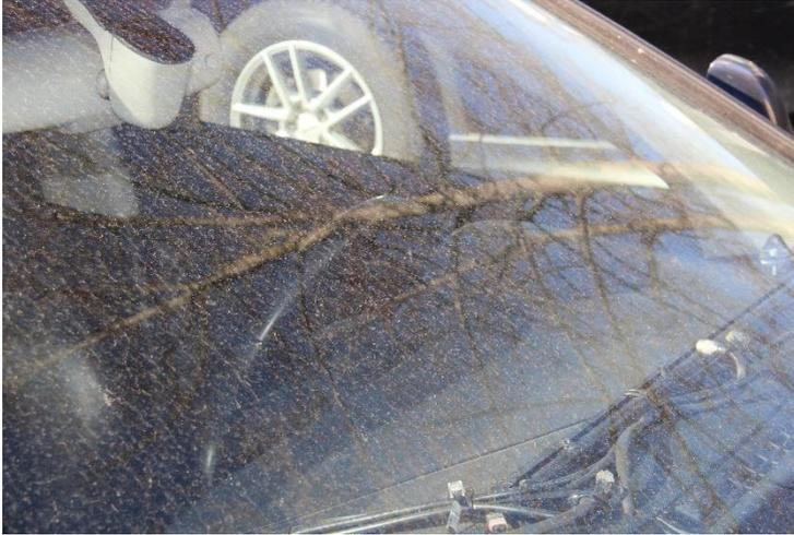
**Abbildung 4.19:** Störung des Empfängers durch Schmutz auf der Windschutzscheibe.
