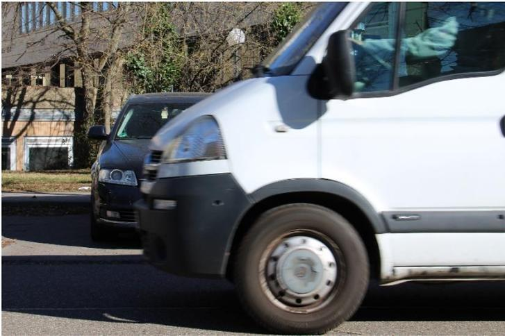
**Abbildung 4.18:** Störung des Kanals verursacht durch ein vorbeifahrendes Fahrzeug. Dies verursacht eine kurzzeitige, aber vollständige Verdeckung des kommunizierenden Fahrzeuges.
