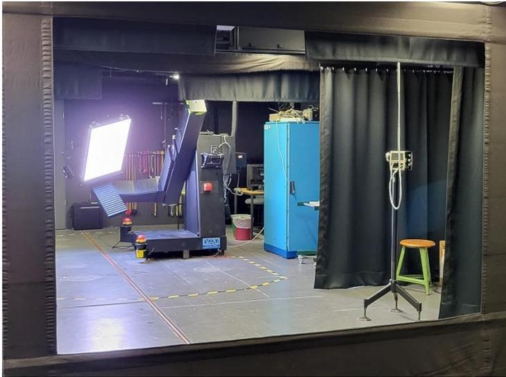
**Abbildung 5.39:** Vermessung des Displays auf dem Kfz-Goniophotometer des Lichttechnischen Instituts. Gemessen wird die Lichtstärkeverteilungskurve im gesamten Halbraum.
