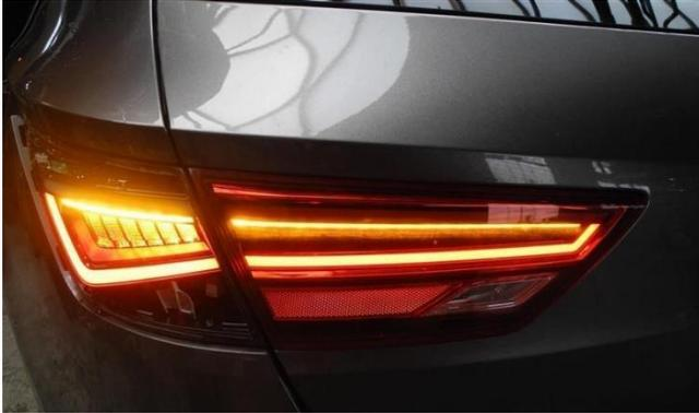
**Abbildung 3.8:** Darstellung einer Heckleuchte. Zu erkennen sind die verschiedenen Signalfunktionen, u. A. Schlusslicht, Bremslicht, Fahrtrichtungsanzeiger [31].
