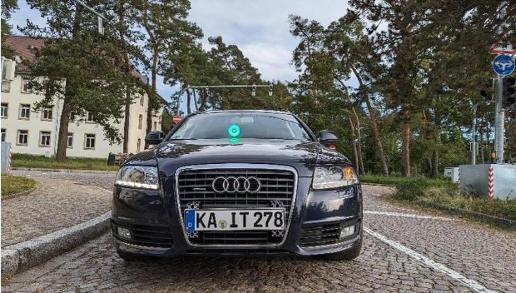
**Abbildung 5.55:** Verzichtsanzeige kommuniziert durch das Aufleuchten der Cyanleuchte am autonomen Fahrzeug.
