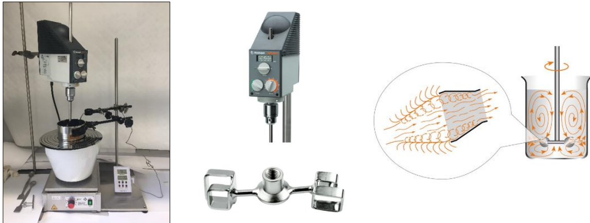
Abbildung 32: Links: Rührsystem; Mitte: Rührer und Rührorgan; Rechts: Rührprinzip (Heidolph Instruments, 2022)
