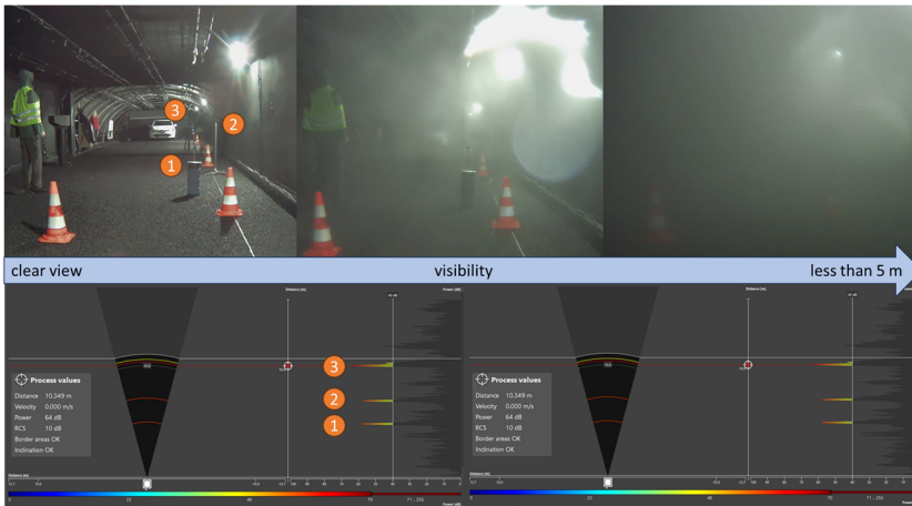
Abbildung 1.1: Radar Performancetest im Nebeltunnel der Cerema bei Seenebel mit Sichtweite von 5 m. Es zeigt sich, dass der Seenebel keinen Einfluss auf das Signal des Radars hat.
