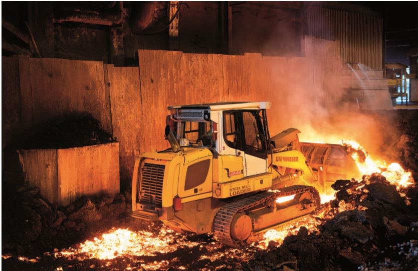
Abbildung 1.1: Fernsteuerung einer Laderauepe im Stahlwerk
