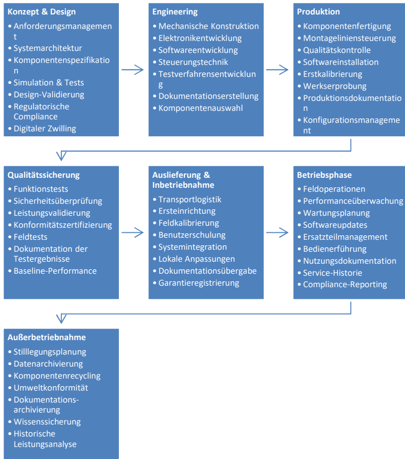
Abbildung 2.1: Übersicht der Lebenszyklusphasen und zugehörige Use-Cases mobiler Landmaschinen
