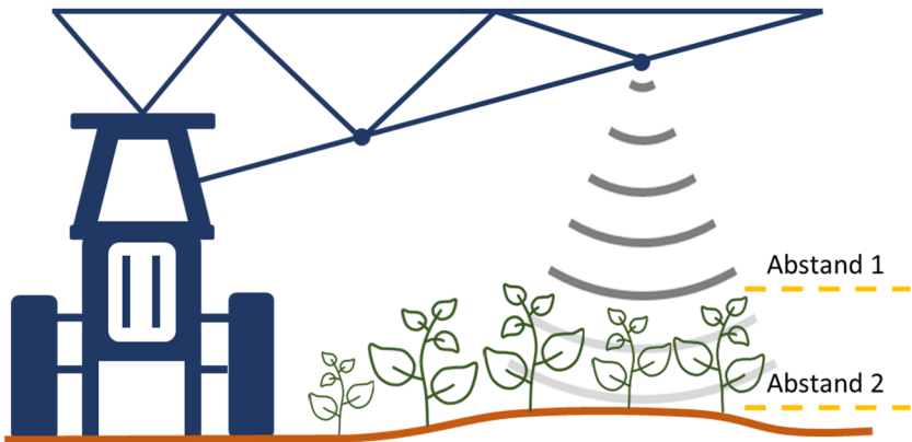
Abbildung 2.1: Höhenkontrolle der Feldaussaat (Boom height control) mittels Radar. Abstand 1: Pflanzenoberseite; Abstand 2: Boden.
