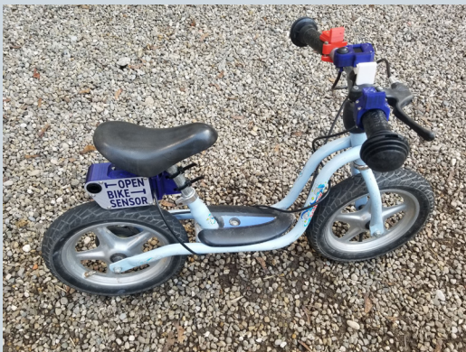
Abb. 23: Positionierung des OpenBikeSensors
