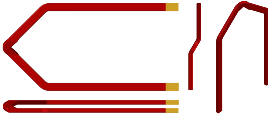
Abbildung 3-4: Hairpin-Steckspule mit Spulengeometrie in F-Form
