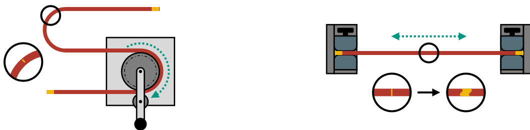
Abbildung 5-4: Wickelprüfung (links) und Haftprüfung (rechts) zur Analyse der Dehnbarkeit und Haftung der Isolationsbeschichtung von lackisoliertem Kupferflachdraht nach (DIN EN 60851-3, S. 13–18)
