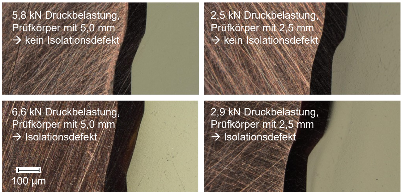
Abbildung 5-15: Schliffbilder der druckbelasteten Proben des Referenzdrahtes nach Prüfung der Isolationsfestigkeit im Salzbadtest
