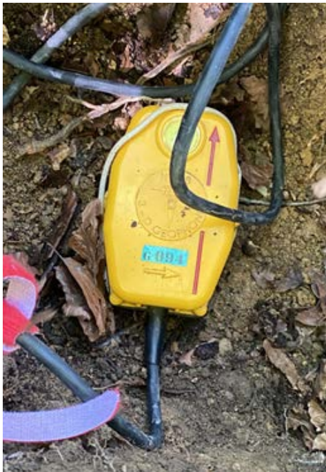
Abbildung 2: Links: 3-C Geofon in einem Graben. Rechts: Datenerfasser mit GPS- Antenne auf der Alkaline Batterie.
