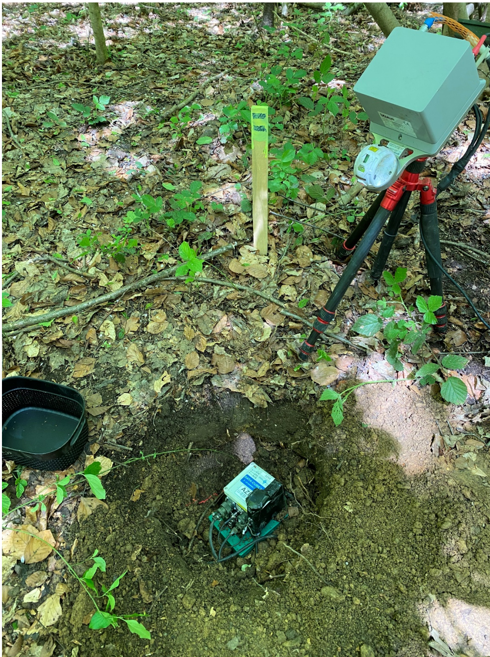
Abbildung 3: Laserkompass für die 3-C Geofon-Orientierung.
