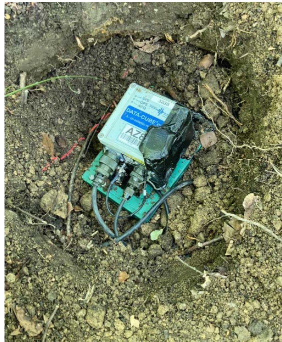
Abbildung 2: Links: 3-C Geofon in einem Graben. Rechts: Datenerfasser mit GPS- Antenne auf der Alkaline Batterie.
