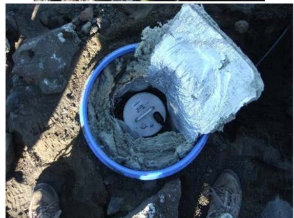
Abbildung 2: Schematische Erläuterung des Prinzips der Installation des Seismometers an der Oberfläche (oben) und Beispiele realer Fälle (rechts).
