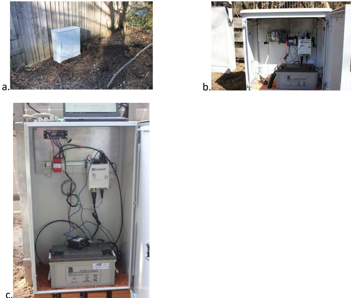
**Abbildung 4: obertägigen Gehäuse in FRIE (a.), WBRU (b.) und FORS (c.). Teil a. zeigt die Situation an der Oberfläche, wenn alles eingerichtet ist. Die Teile b. und c. zeigen das Innere des Schrankes mit seismischer und elektrischer Ausrüstung.**
