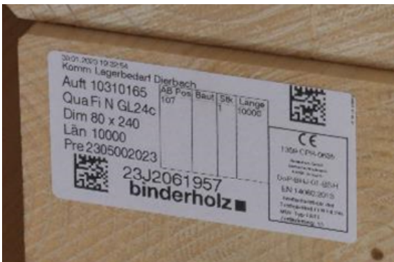
Abb. 14: Selbstklebend aufgebrachte CE-Kennzeichnung, GL24c
