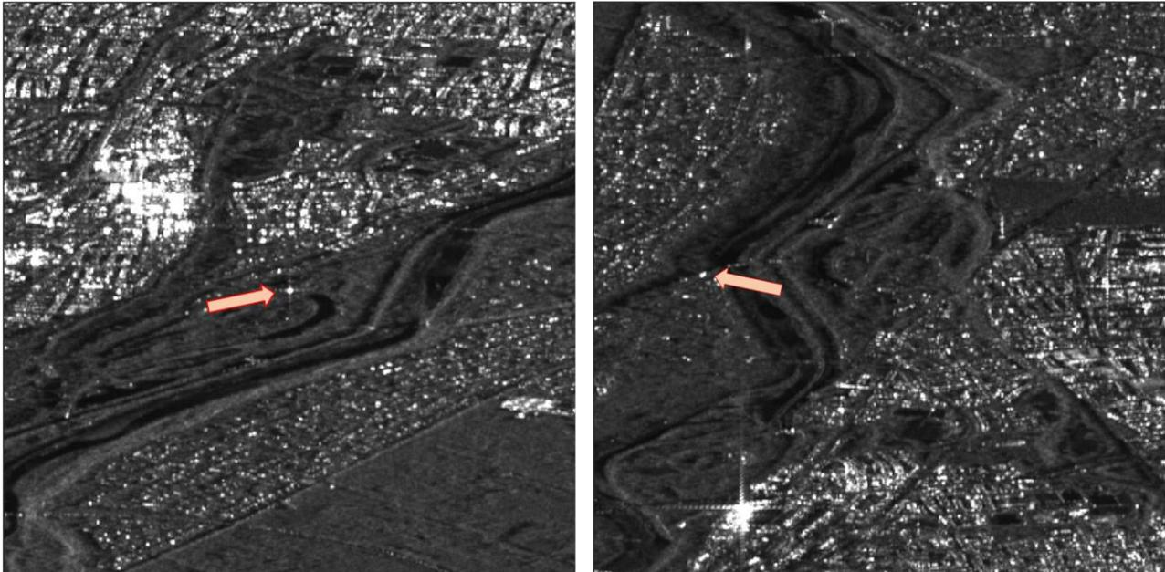
Abbildung 12: Ausschnitte der Mittlere-Amplituden-Bilder von Maria-Einsiedel-Bad. Links: aufsteigender Orbit 117. Rechts: absteigender Orbit 168. Pfeile kennzeichnen die Position des Transponders
