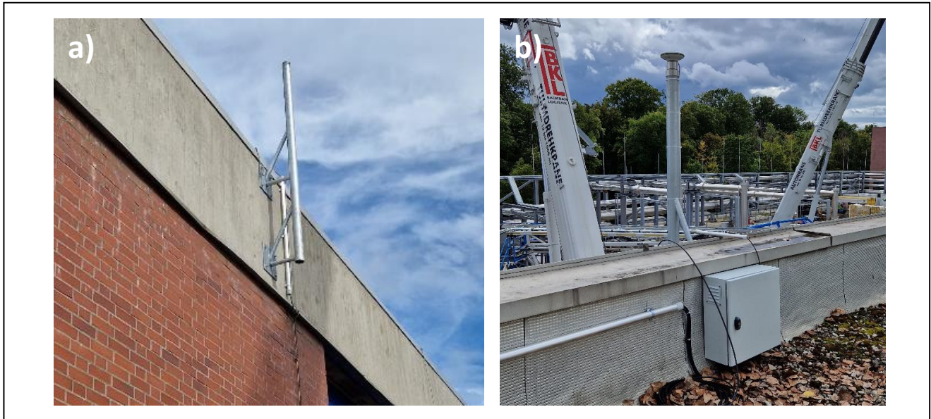
Abbildung 4: GNSS-Station Schäftlarnstraße mit Antennenhalterung (a). Die Station hat gute Rundumsicht, gelegentliche Störungen durch Baufahrzeuge sind jedoch nicht ausgeschlossen (b). Bildquelle: Ambrus.
