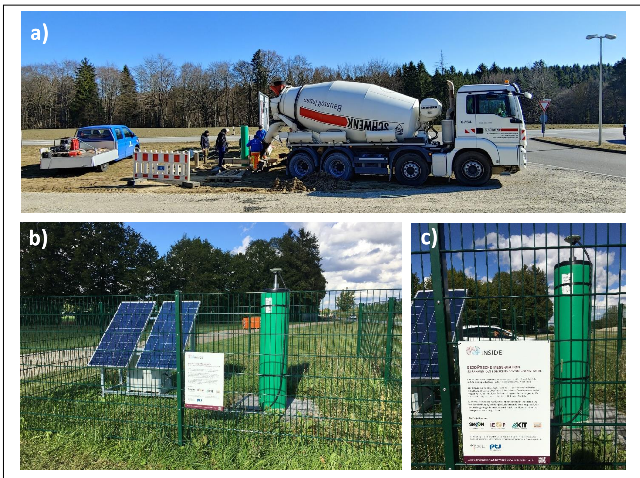
Abbildung 6: GNSS-Station Baierbrunn. Es handelt sich um die einzige Pfeilerstation, die im Messgebiet realisiert werden konnte. Über tiefreichende Betonfundamente ist eine optimale Ankopplung der Antenne an den Boden gewährleistet. Bildquelle: (a) Westerhaus, (b,c) Ambrus.
