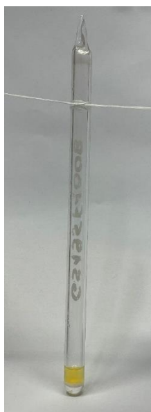
Abbildung 83: Unter Vakuum abgeschmolzene Borosilikatglas-Ampulle.
