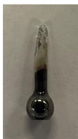
Abbildung 85: In einer Kapillare abgeschmolzene Probe für eine DTA-Messung.
