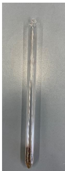
Abbildung 84: Unter Vakuum abgeschmolzene Quarzglas-Ampulle.
