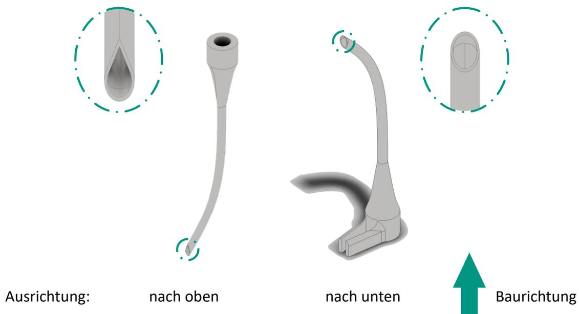
**Abb. 8.5:** Vergleich der Anschlussvarianten für die Ausrichtung in Baurichtung nach oben und nach unten. Um überhängende Flächen in den Anschlüssen zu vermeiden, wurde bei der nach oben gerichteten Variante ein tropfenförmiger Querschnitt genutzt.
