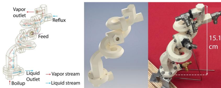
**Abb. 2.6:** Von Mardani et al. entwickelte helikale, im SLA-Verfahren hergestellte Rektifikationskolonne. Links: Schematische Skizze der Kolonne mit Strömungswegen; Mitte: computerunterstützte Entwurfs (englisch: computer-aided design) (CAD)-Modell der Kolonne; Rechts: Kolonne mit Anschlüssen. Abdruck aus [95], ©(2016) mit Genehmigung von Elsevier.
