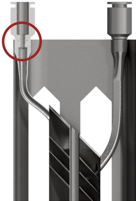
**Abb. J.1:** Schnittdarstellung von HeliDist der zweiten Anschlussgeneration mit Pneumatik Schnellkupplung. In Rot markiert: Verengung des Strömungsquerschnitts.
