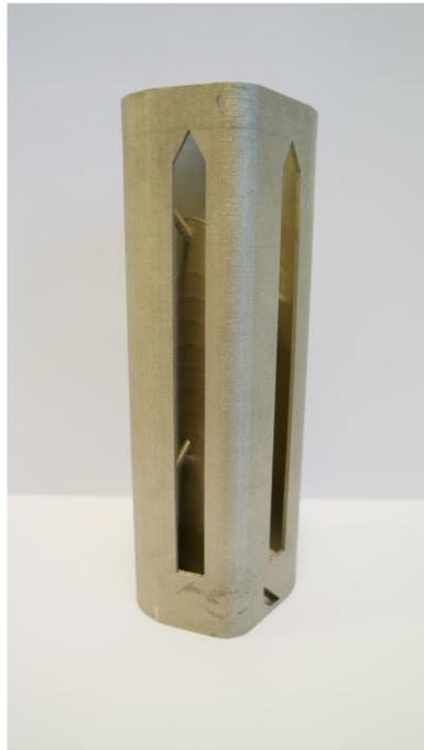
**Abb. E.2:** Seitenansicht einer HeliDist-Einheit der zweiten Anschlussgeneration mit 12 Windungen.
