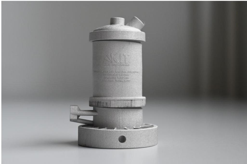
**Abb. 8.16:** Erfolgreich mit dem BJT/M-Verfahren hergestellte HeliDist-Einheit mit 6 Windungen und einer Ganghöhe von 5 mm im für das BJT/M-Verfahren optimierten Design.
