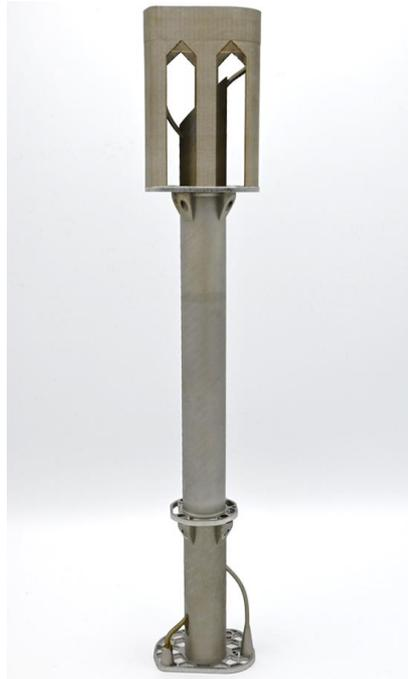
**Abb. E.5:** Bild des Aufbaus einer HeliDist-Einheit der dritten Anschlussgeneration mit 20 Windungen aus Mittelmodul mit 12 Windungen. Kopf- und Sumpfmodul jeweils 4 Windungen.
