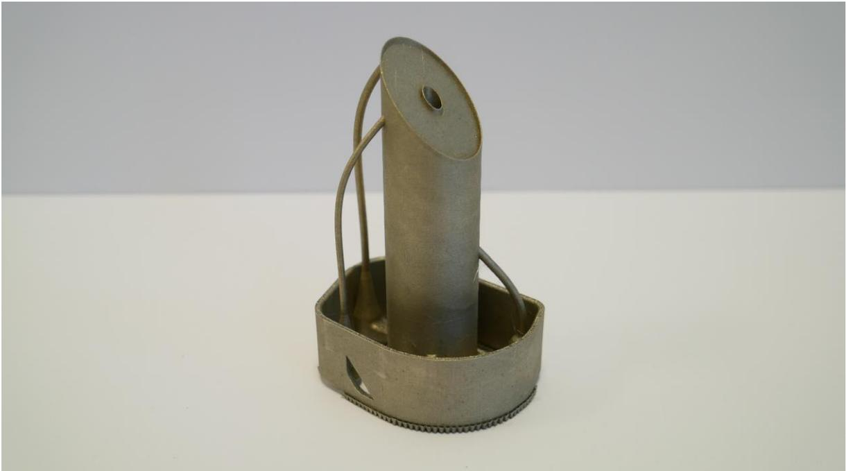
**Abb. E.1:** HeliDist-Einheit der ersten Anschlussgeneration mit 4 Windungen.
