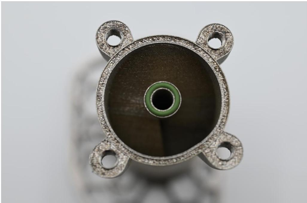
**Abb. E.7:** Detailansicht oberer Flansch mit teilweise eingelegter Dichtung einer HeliDist-Einheit der 3. Anschlussgeneration
