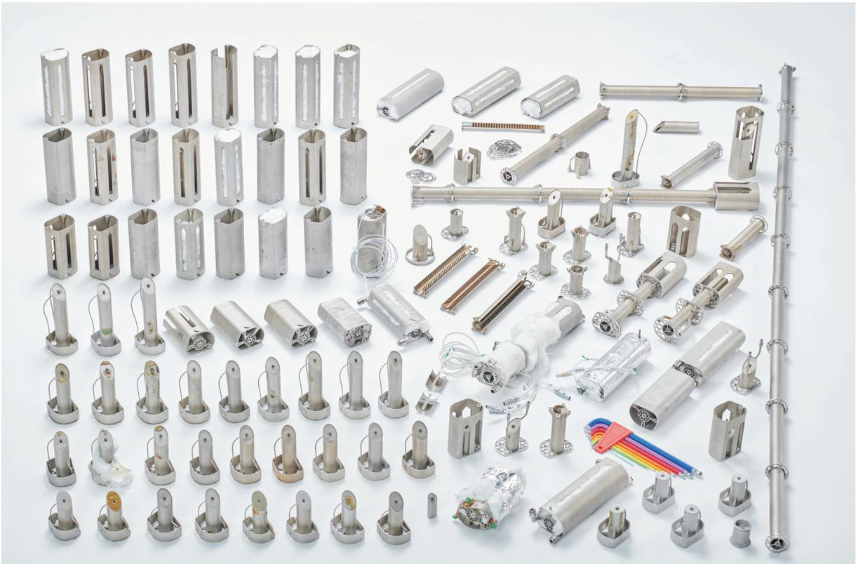
**Abb. 9.2:** Auswahl der hergestellten HeliDist-Einheiten. Teilweise mit Temperatursensoren und Isolation. Metrischer Sechskantschlüsselsatz als Größenvergleich. Foto: Amadeus Bramsiepe, KIT.
