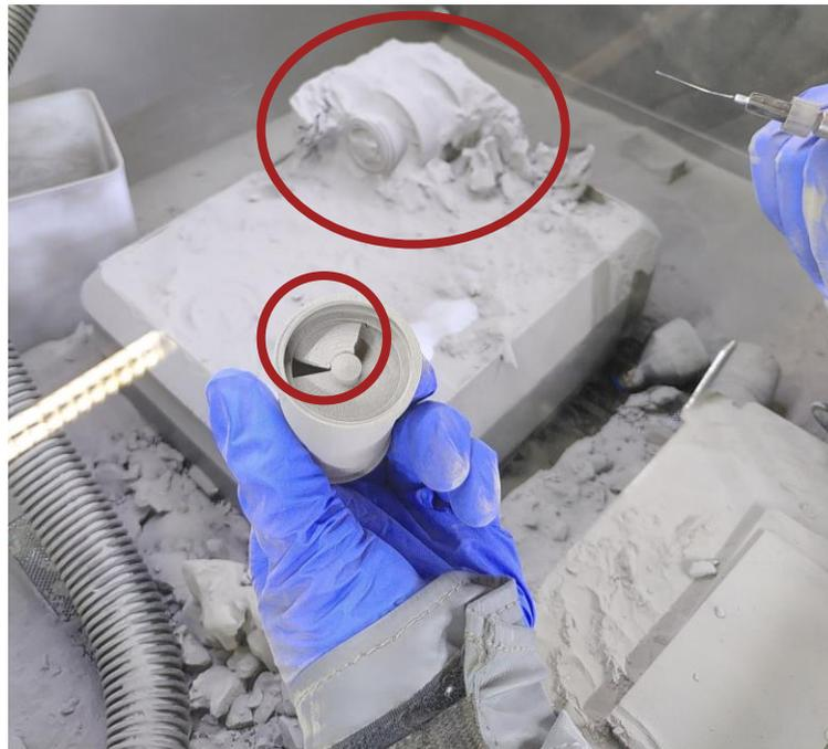
**Abb. 6.4:** Verfestigtes Pulver nach der Härtung des Binders am Beispiel der HeliDist-Einheit im BJT/M-Design (vgl. auch 8.3). Im vorderen, markierten Bereich ist verfestigtes Pulver aus einem spiralförmigen Kanal dargestellt. Zudem zeigt das teilweise entpulverte Pulverbett im hinteren Teil des Bildes die hohe Stabilität von eben diesem.
