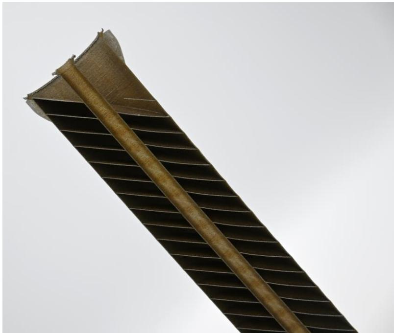
**Abb. E.8:** Ansicht eines erodierten Schnitts durch eine HeliDist-Einheit der 3. Anschlussgenerati-
