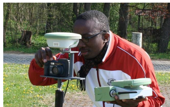
Abbildung 5: Aufnahmekampagne 2012 auf dem TrÜbPl Hammelburg. Das Foto zeigt William Nguatem (UniBw) bei der Bildaufnahme mit Unterstützung eines Satellitenpositionierungsdienstes.
