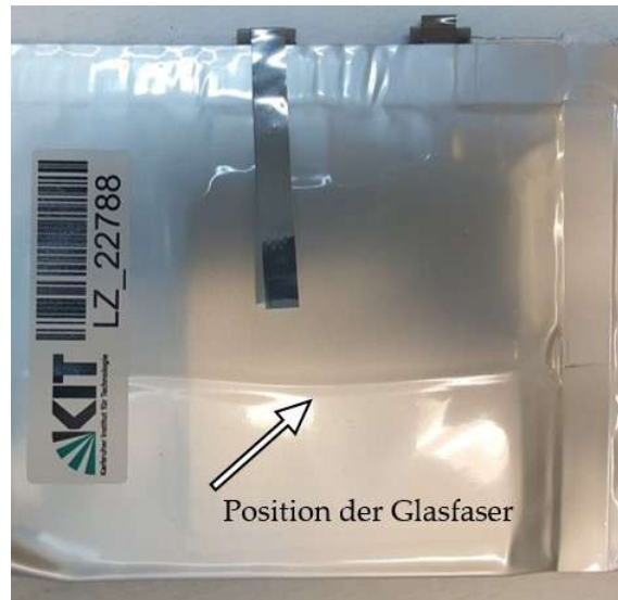
Abb. 3.4: Foto einer einlagigen NCM111/Graphit-Laborpouchzelle. Die auf dem Zellstapel positionierte, integrierte Glasfaser zeichnet sich deutlich durch die Pouchfolie ab.
