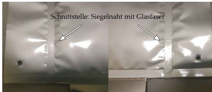
Abb. 3.2: Eintritts- und Austrittspunkt der Glasfaser in die Zelle. Beim Versiegeln der Seiten wurde die Glasfaser lediglich zwischen die Pouchfolien gelegt.
