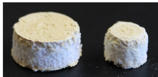
(a) Für 116 h bei 150 °C getemperte Probe T92.130 ID=18. (b) Randgefüllte Probekörper mit Feinspachtel.
