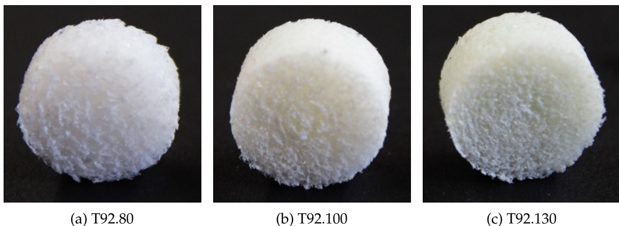
Abb. 4.4: Draufsicht der Probekörper (längs zur Extrusionsrichtung) für die Materialien T92.80, T92.100 und T92.130 (von links nach rechts) mit offenporiger Schaumstruktur an den Schnittflächen.
