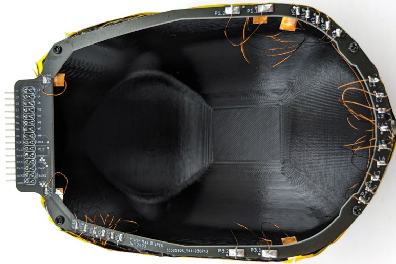
Abbildung 4.19: Platine zur Verkabelung der Sensorelemente
