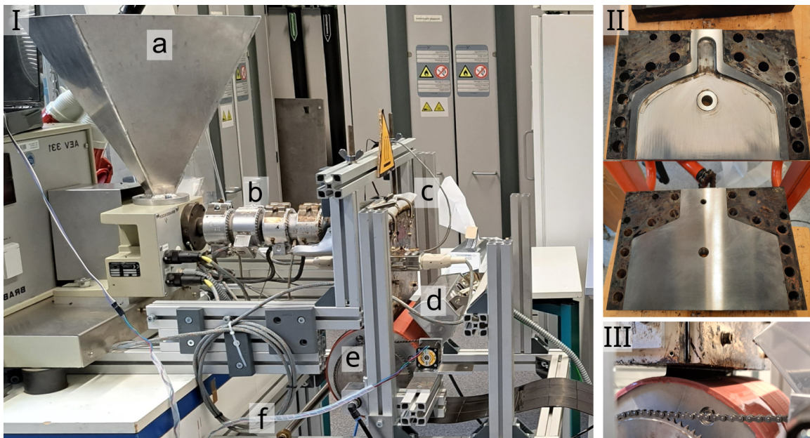
Abbildung 4.7.: Produktionsteil. I: Gesamtansicht Produktion. a: Fülltrichter b: Extruder zur Bereitstellung der Schmelze c: Breitschlitzdüse d: Vorheizung Strukturwalze. Verhindert schnelles Abkühlen der Schmelze beim Auftreffen auf Walzenoberfläche e: Strukturwalze. f: Luftkühlung. II: Innenansicht Düse: Nach Eintritt durch die Flanschbohrung erfolgt die Verteilung der Schmelze mit der Kleiderbügelstruktur. Die Düsenbreite beträgt 200 mm, die -höhe 800 \mu\text{m} . III: Extrusionszone: Die flüssige Thermoplastschmelze (schwarz) wird mit der Düse auf die gesamte Breite der Strukturwalze appliziert.
