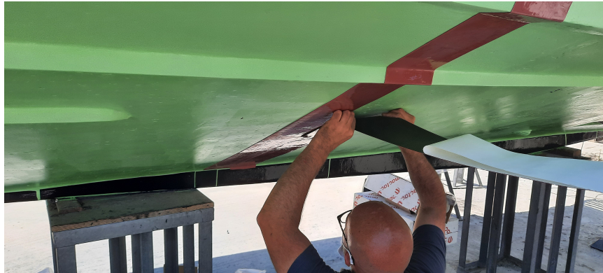
Abbildung 6.1.: Aufbringen der Folie: Die selbstklebende Strukturfolie wurde bahnweise nahtlos aufgeklebt. Die Bahnen waren dabei quer zur Strömungsrichtung ausgerichtet.
