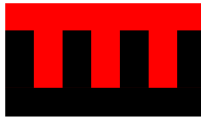
Abbildung 4.12.: Variante Schutzfolien: Die selbstklebende Folie legte sich flächig auf die Deckel der Säulen und der Kompartimentwände ohne Füllung der Zwischenräume. Bei Abziehen der Kaschierfolie kam es zur Zerstörung der Struktur durch Ausreißen der Säulen. Bei der Gussfolie kam es zur vollständigen Füllung der Struktur. Beim Abziehen waren die Kräfte flächiger verteilt, wodurch die Struktur weniger belastet wurde. Auch haftete das Silikon weniger stark an der PE-Strukturfolie.
