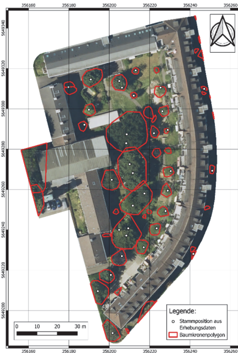
Abb. 3: Best-Fit mittels SVR-Gesamt am Beispiel eines Wohnblocks. Detektierte Kronenpolygone in Rot, Stammposition aus Erhebungsdaten in Weiß. Eigene Darstellung, DOP bereitgestellt von Geobasis NRW.
