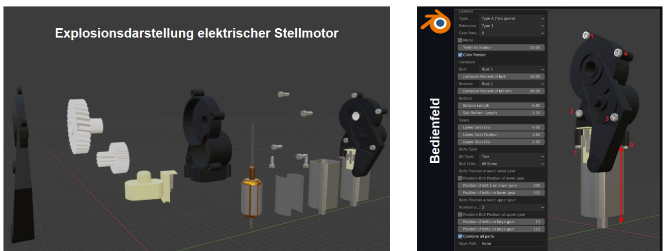
Abbildung 4.11: Blender Add-On zur synthetischen Erzeugung von CAD-Objekten des Elektromotors (eigene Darstellung in Anlehnung an Wu & Zhou et al. 2022).
