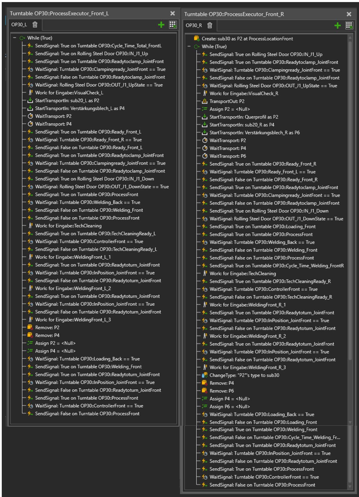
Abbildung A9.4: Visual Components Prozessablaufkonfiguration der Handhabungsseite im Anwendungsbeispiel (eigene Darstellung in Anlehnung an A_Jung 2023).
