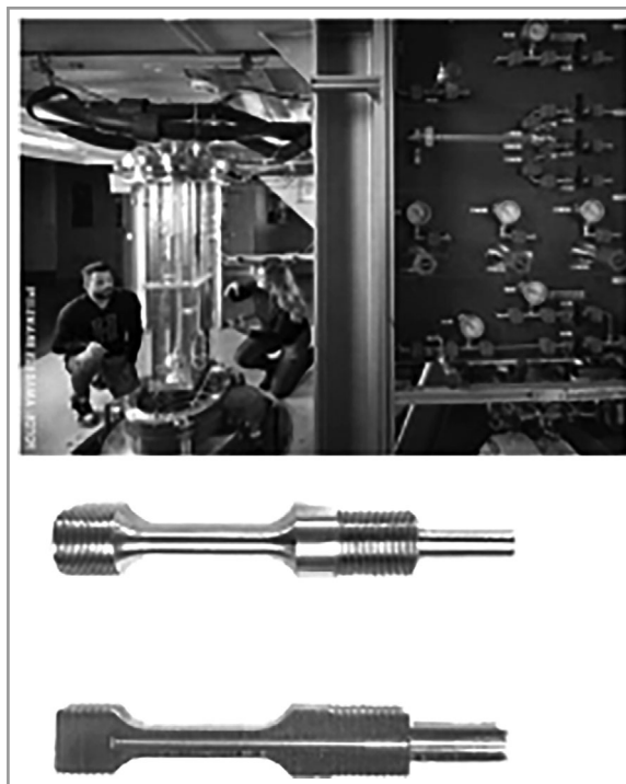
Abbildung 7. Materialanalysen bei 20 K in einem Kryostaten zum Versagensverhalten mit gasförmigem oder flüssigem Wasserstoff in einer Hohlzugprobe.
