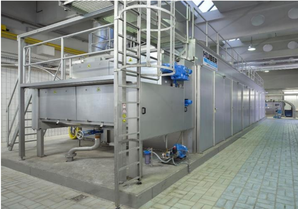
Abbildung 2: Bandrockner auf einer kommunalen Kläranlage zur Trocknung von rund 21.000 t entwässertem Klärschlamm pro Jahr und einer Nahwärmeauskoppelung von rund 400 kW bei 65-70°C (HUBER 2019)
