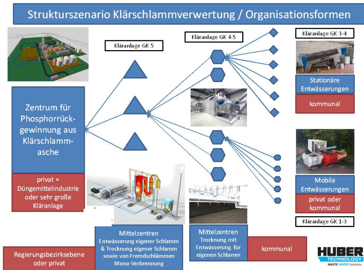
Abbildung 4: Szenario zur P-rückgewinnung unter Einbindung von Verbrennung, Trocknung und Entwässerung von Klärschlamm (HUBER 2017)
