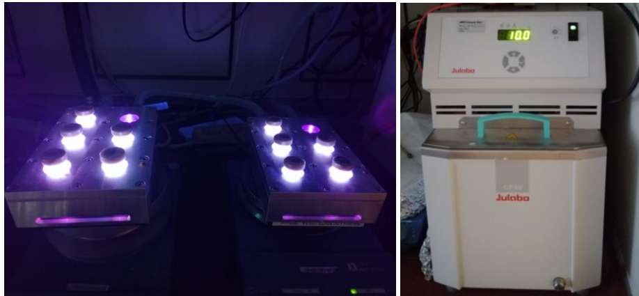
Abbildung 74: Versuchsaufbau zu den durchgeführten Belichtungsexperimenten: Rührer und Belichtungsreaktor (links) und Thermostat (Rechts).
