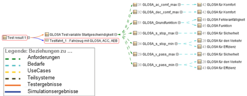
Abbildung 7.17: Traceability von Testergebnis zu Bedarfen realisiert mit Hilfe von unterschiedlichen Beziehungen.
