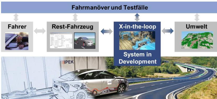
Abbildung 2.22: IPEK-X-in-the-Loop-Ansatz zur Validierung des Systems mit dessen Umwelt und dessen vernetzten Systemen (Albers & Düser, 2008; Albers, Behrendt et al., 2016).
