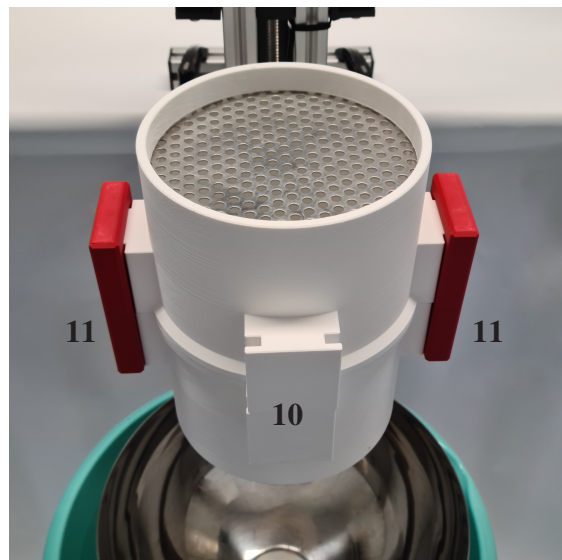
(c) Doppelsiebsystem zum einfachen Wechsel der Siebe.
