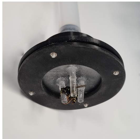
(d) Greifer beim Halten eines Insekts. Die Flexibilität der Finger verhindert eine Beschädigung der Probe.
