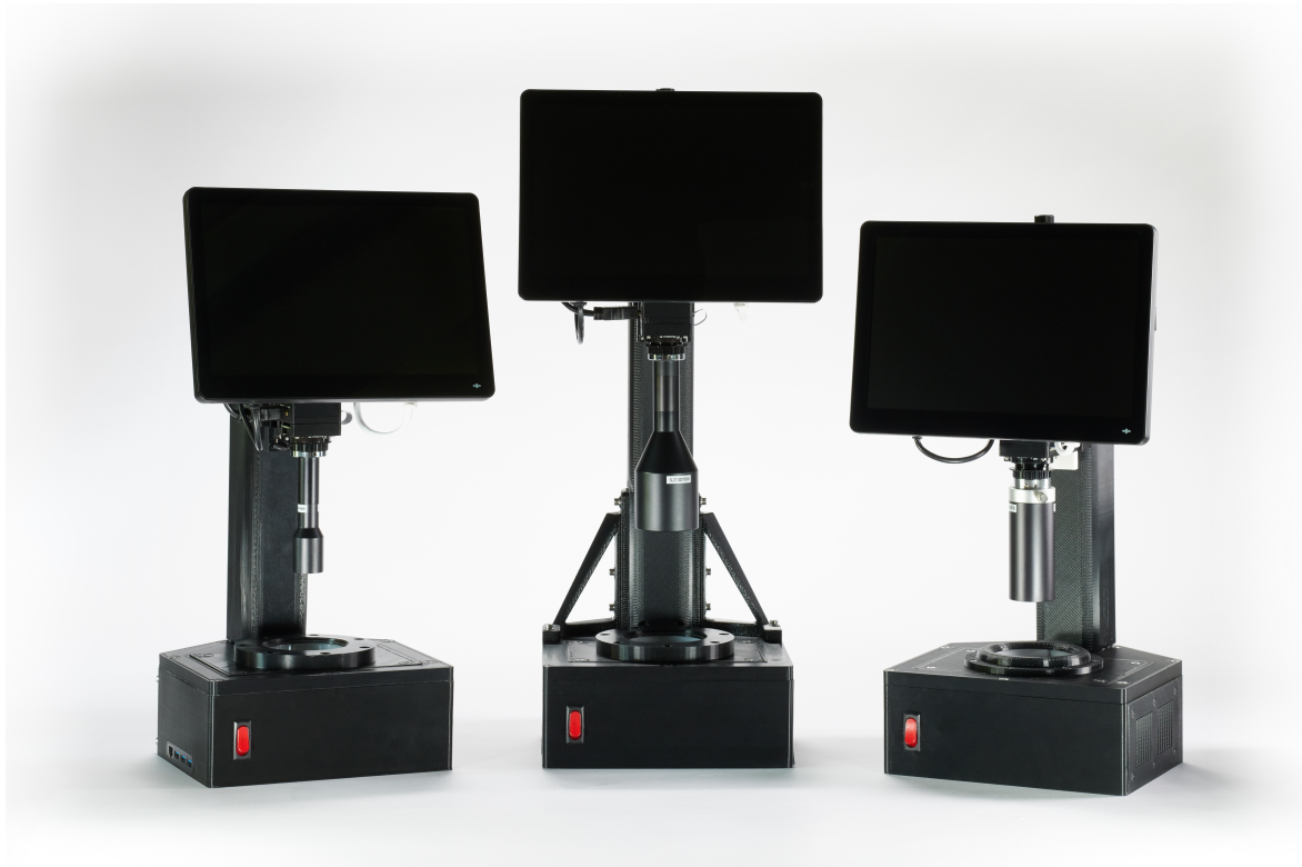
Abbildung 5.5: Drei verschiedene Versionen des Standalone Entomoscopyes für Insekten unterschiedlicher Größenkategorien, < 6 mm (links), 6 mm - 12 mm (rechts) und 12 mm - 25 mm (mitte). Die Versionen unterscheiden sich in der Höhe der verwendeten Aluminiumprofile, um die unterschiedliche Länge der Objektive, sowie unterschiedliche Objektabstände zu kompensieren. Zur Versteifung besitzt das Standalone Entomoscope für große Insekten (mitte) Winkel, die die Aluminiumprofile abstützen.
