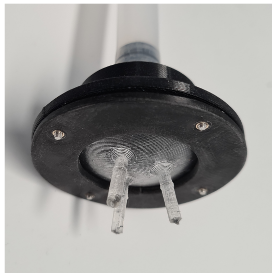
(b) Geöffneter Greifer durch Druck auf der Innenseite der Membran.
