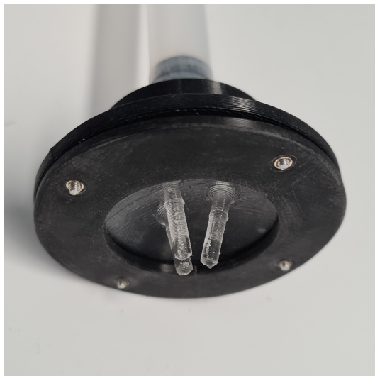
(c) Geschlossener Greifer durch Unterdruck auf der Innenseite der Membran.
