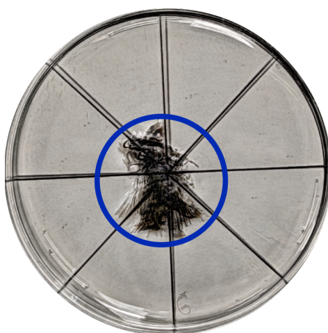
(a) Ablagekreis der 15 mm Probe mit einem Durchmesser von 25 mm.
