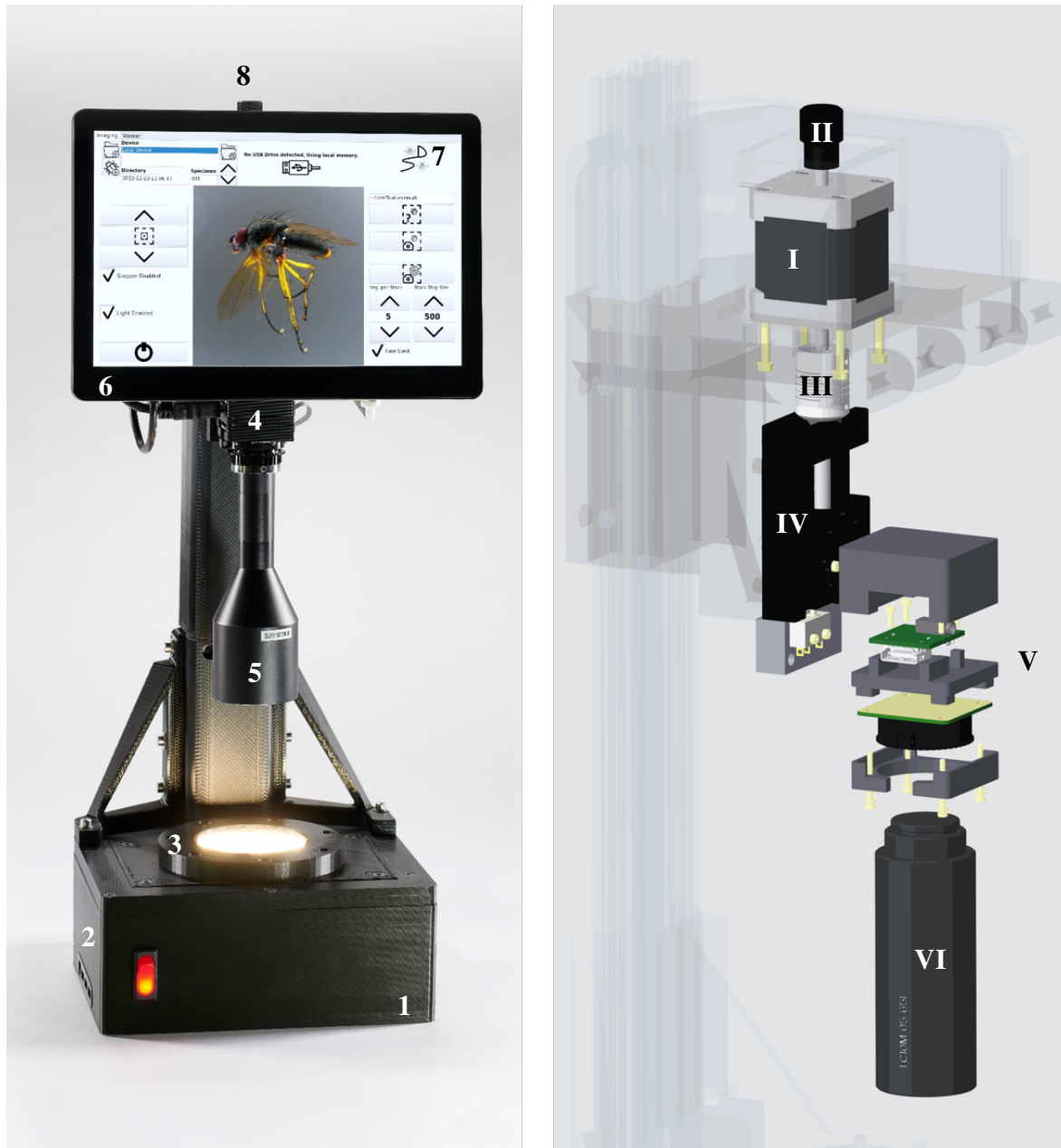
Abbildung 5.2: Standalone Entomoscope (links), mit (1) Basis, (2) Universal Serial Bus (USB)- und Netzwerk-Hub, (3) Beleuchtung, (4) 12-MP-Kamera mit (5) telezentrischem Objektiv, (6) 10-Zoll-HD-Touchscreen, (7) grafischer Benutzeroberfläche und (8) Fokussierad. Weiterhin dargestellt ist die 3D-Ansicht der Focus Stacking Einheit (rechts), mit (I) Schrittmotor, (II) Fokussierad, (III) Kupplungsadapter, (IV) Lineartisch, (V) Kameraeinheit mit Raspberry Pi HQ-Kamera und HDMI-Adapter, (VI) Objektiv. Modifiziert nach [91].
