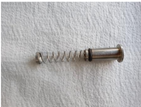
Abbildung 12 Links: Durch Löten verbundene Zellbestandteile (Edelstahlstempel, Edelstahlfeder, Edelstahlplättchen); rechts: Vergleich der spez. Kapazitäten eines Superkondensators in 1\text{M Na}_2\text{SO}_4 gemessen mit Standardzelle (rot) und gelöteten Komponenten (schwarz) 1. Messung.
