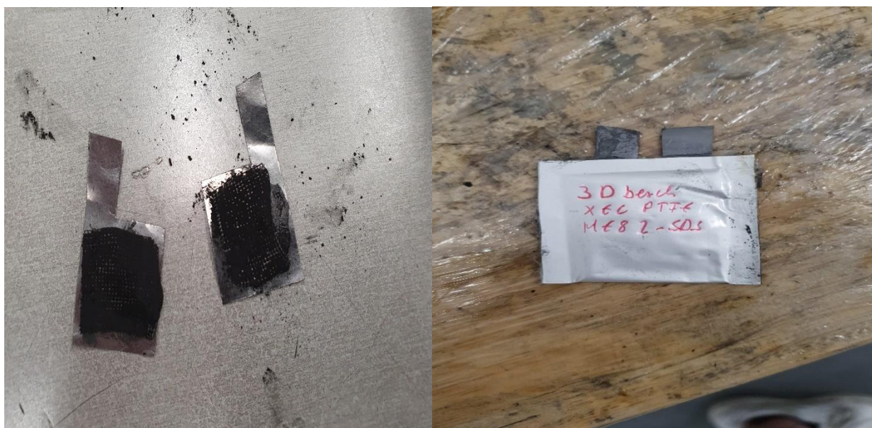
Abbildung 75 additive gefertigte Elektroden auf Grafit-Folie geklebt (links); fertige Pouch-Zelle (rechts) mit ME_82_SDS_0,1M_KCl.
