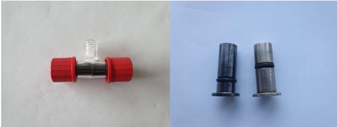
Abbildung 17 Neues Zelldesign (links); Vergleich beschichteter Edelstahlstempel und Standard-Edelstahlstempel (rechts).
