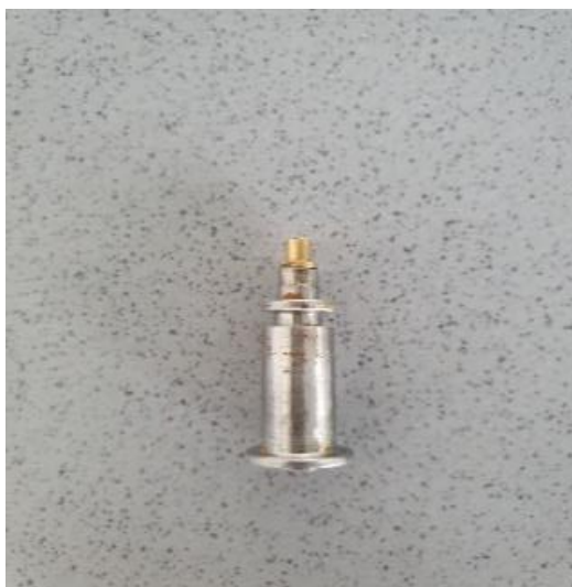
Abbildung 14 Edelstahlstempel mit Federkontaktstift (links); Lade-/Entladeexperimente Zelle mit Federkontaktstift (rechts) in 1 M \text{Na}_2\text{SO}_4 .
