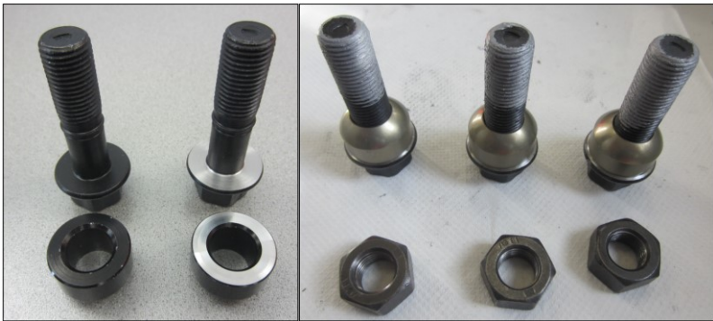
Abbildung 7.60: Radschraube: Variation WFP_SK
