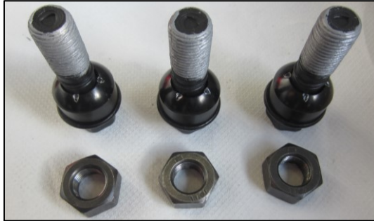
Abbildung 7.50: Schmierfett im Gewinde der Radschraube: Variation WFP_SN
