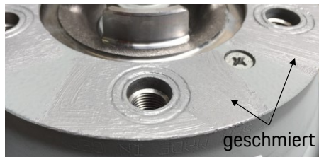
Abbildung 7.33: Schmierfett zwischen Bremsscheibe und Rad
