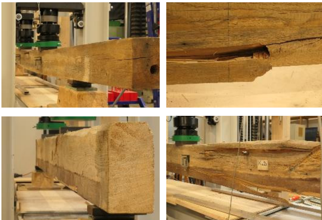
Abbildung 41: Biegeversuche in Anlehnung an DIN EN 408; Dachbalkenhälfte D5/Nord nach dem Abnehmen der Messschienen und Biegezugversagen (oben); Kellerbalkenhälfte K2/Nord vor dem Versuch und kombiniertes Versagen in der Biegezug- und Biegedruckzone (unten)
