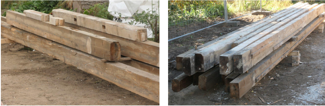
Abbildung 21: Dach- und Kellerbalken für Prüfungen (links) und für Projekt (rechts)
