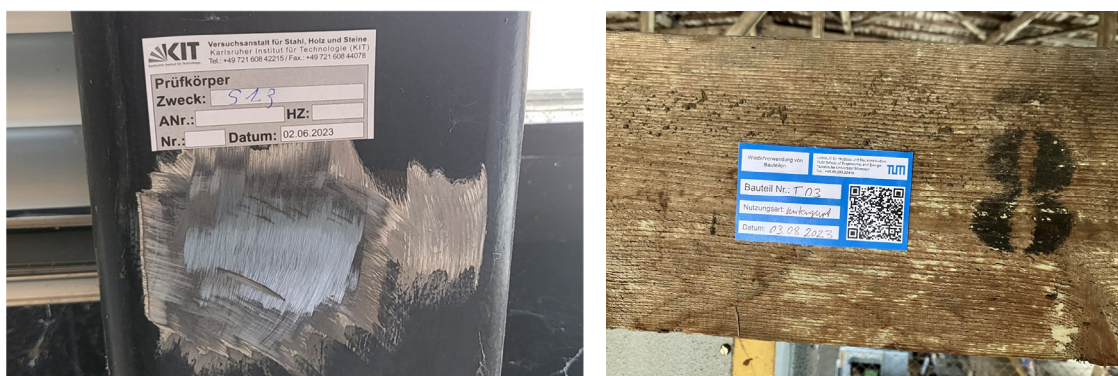
Abbildung 13: Exemplarische Etikettierung einer Stahlstütze (links) und eines Holzbalkens (rechts)
