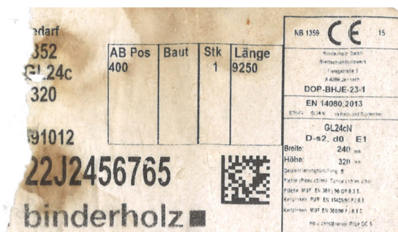
Abbildung 46: Bereits während der Bauphase beschädigte selbstklebend aufgebrachte CE-Kennzeichnung (wahre Größe 80x40 mm 2 ) einer Stütze aus GL24c 9250x240x300
