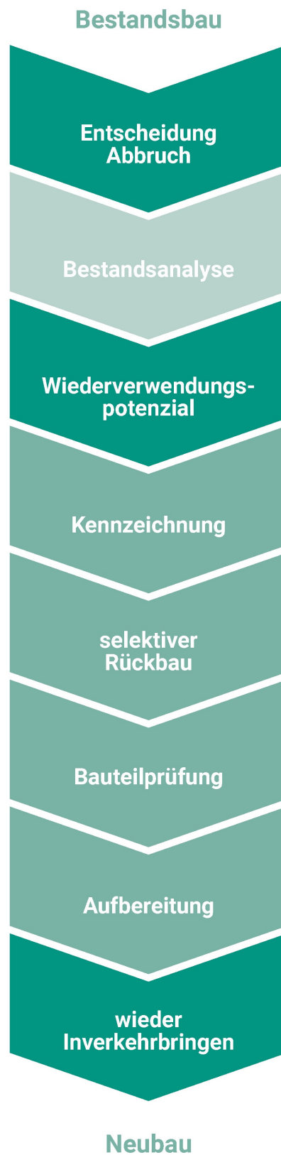
Abbildung 8: Prozess zur Wiederverwendung von tragenden Holz- und Stahlbauteilen
