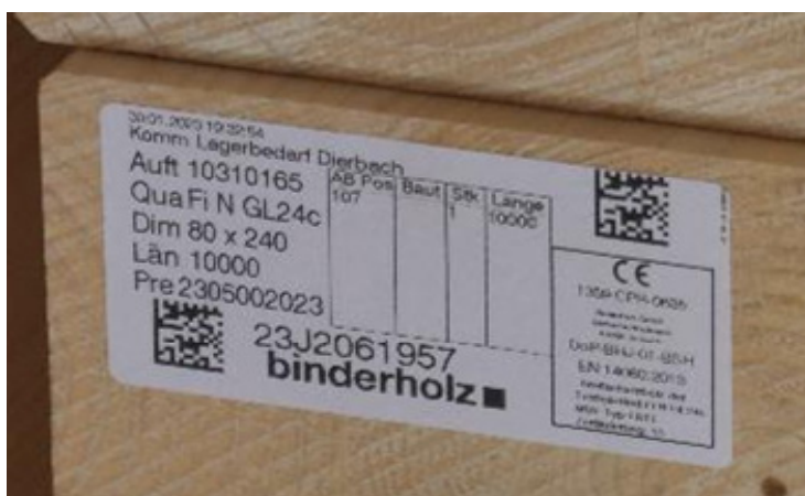
Abbildung 45: Formale Vorgabe für eine CE-Kennzeichnung und selbstklebend aufgebrachte tatsächliche Kennzeichnung
