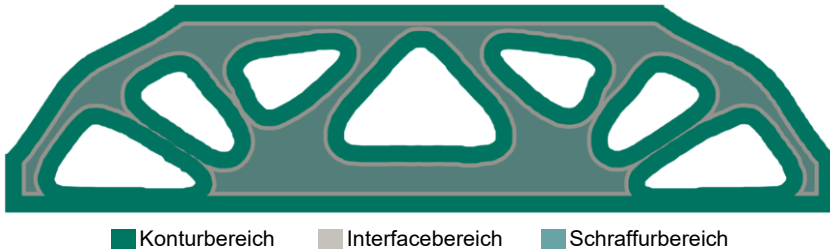
Abbildung 4.61: Resultierender Designvorschlag der entwickelten TopOpt-Methode inklusive der drei porenbehafteten Bereiche für Optimierungsfall 4.1
