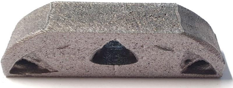
Abbildung 4.55: SLM-gefertigter Designvorschlag der entwickelten TopOpt-Methode für Optimierungsfall 3.2 nach Czink et al. (2023)
