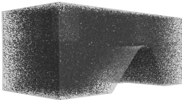
Abbildung 4.2: Ausschnitt der aus \mu\text{CT} -Aufnahmen rekonstruierten Mikrostruktur des Demonstrators: Defektfreie Bereiche (helle Regionen) und entstehende Poren (dunkle Regionen)
