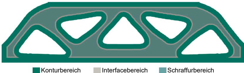
Abbildung 4.62: Resultierender Designvorschlag der standardisierten Topologieoptimierung inklusive der drei porenbehafteten Bereiche für Optimierungsfall 4.1
