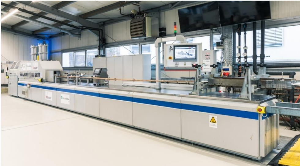
Abbildung 4-4: Pultrusionsline von Nanjing LYT. Am Bedienpanel über der Kühlstrecke werden die Prozessparameter eingestellt. Ein Druckmesssystem erlaubt eine kontinuierliche Überwachung des Kavitätsdrucks.
