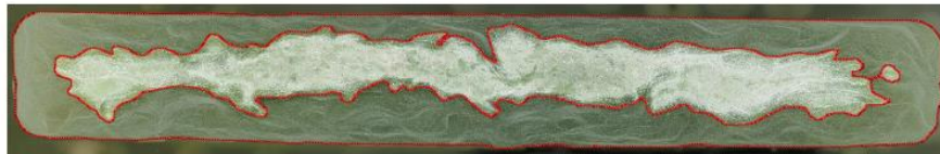
Abbildung 4-11: Makroskopisches Bild einer präparierten Probe. Die Imprägniergüte wird durch das Verhältnis des gesamten Profilquerschnitts zur trockenen Profilfläche berechnet.
