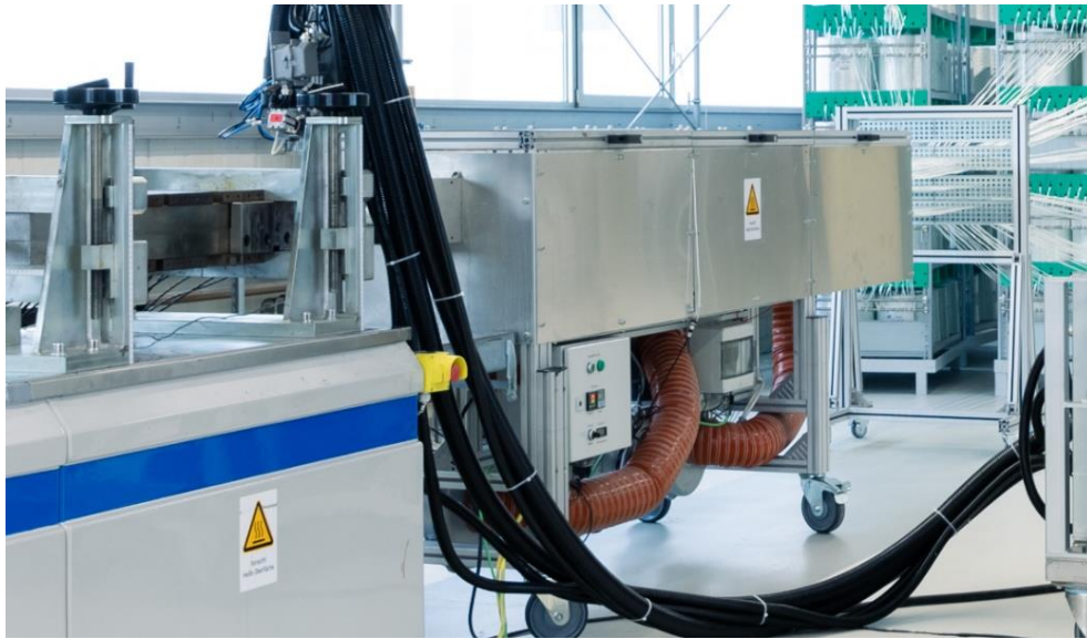
Abbildung 4-2: Die Fasern werden im Trockenofen über eine Länge von drei Metern durch mehrere Ebenen mit Keramikösen geführt und mittels Umluft getrocknet, bevor sie in das Pultrusionswerkzeug gelangen.
