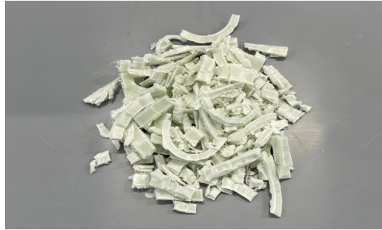
Abbildung 4-9: Zerkleinerte Profile zur Bestimmung des Restmonomergehalts mittels Soxhlet-Extraktion und anschließender RP-HPLC
