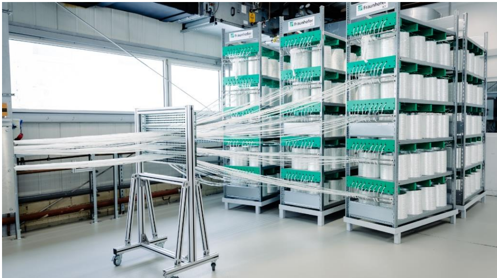
Abbildung 4-1: Regale mit Glasfaser-Bobbins mit Innenabzug. Die einzelnen Rovings werden am Regal durch Breaker Bars umgelenkt, um die beschichteten Faserbündel aufzubrechen. Anschließend werden sie durch Keramikösen in den Trockenofen geführt.
