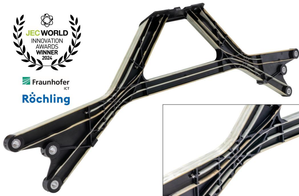
Abbildung 6-1: Domstrebe des Audi A8 als Demonstrator für den Einsatz von in-situ Pultrusionsprofilen zur lokalen Verstärkung von Spritzgießbauteilen [163]
