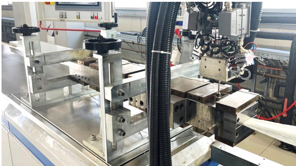
Abbildung 4-3: Pultrusionswerkzeug in Aufspannvorrichtung mit elektrischen Heizplatten. Die gesamte Aufspannvorrichtung ist schwimmend gelagert und ermöglicht so die Messung der Abzugskraft.
