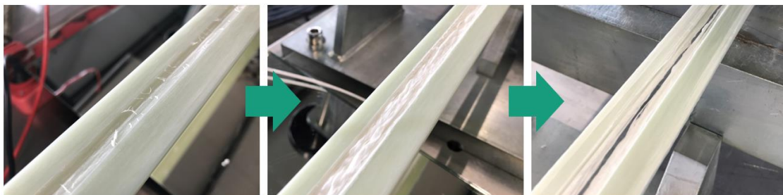
Abbildung 4-17: Resultat einer irreversiblen Matrixanhaftung im Werkzeug. Zunächst entsteht eine Riefe, die fortlaufend tiefer wird und schließlich zu einem Profilabriss führt.
