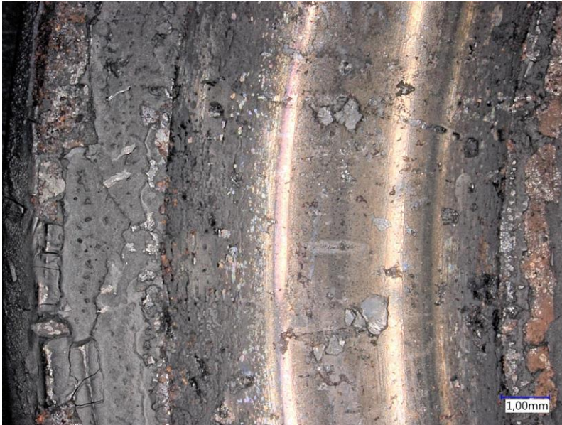
Abbildung 5.22: Oberfläche des Innenrings des Axialkugellagers nach Versuchsende. In der Mitte ist die Oberfläche der Laufbahn sichtbar, auf der das Graphit überwiegend abgelöst ist. An den Rändern ist Graphit als mattschwarze Beschichtung sichtbar.
