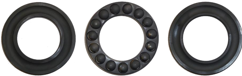
Abbildung 5.13: Beschichtete Lagerteile (v. l. n. r: Innenring, Käfig mit Kugeln, Außenring)
