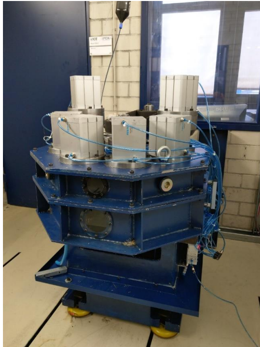
Abbildung 5.10: Zweite Generation des RPR zum Testen von Axialkugellagern mit Graphitschmierung
