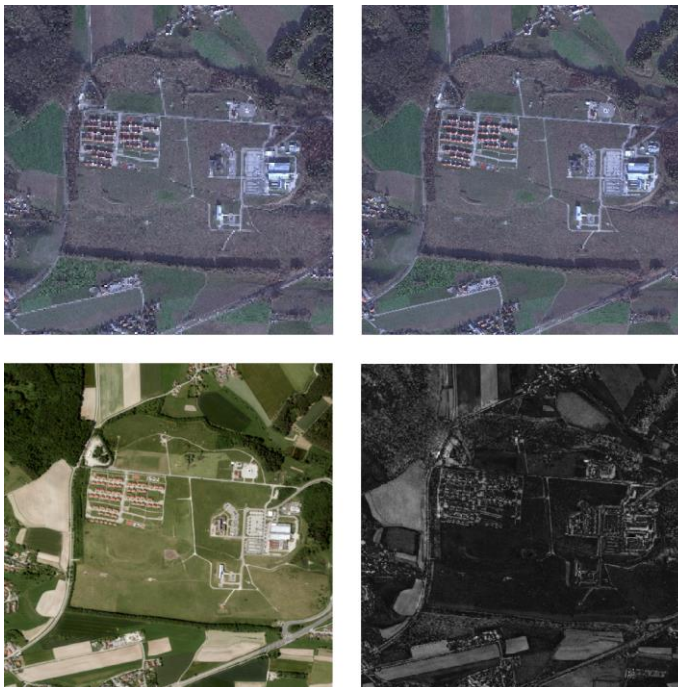
Abb. 3: Beispiel für Super Resolution. Oben: niedrig aufgelöste Eingangsszene und Super-Resolution-Ergebnis. Unten: Referenzbild und Differenzbild zwischen Super Resolution und Referenz.
