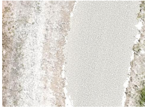
Abb. 3: Ausschnitt des Kiesplatzes mit Pfütze. Man erkennt die aus der photogrammetrischen Punktwolke ergänzten Punkte auf der Wasseroberfläche.
