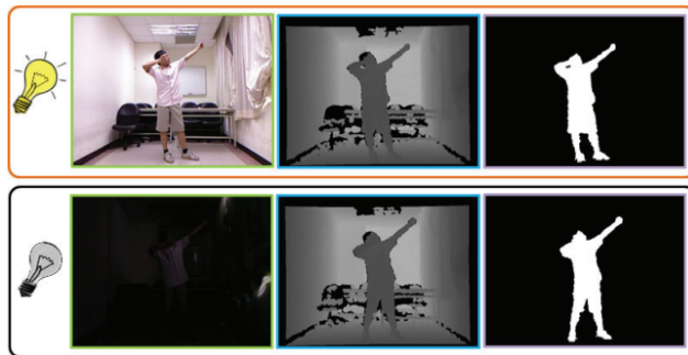
Abbildung 3.8: Einzelbild mit Farb-, Tiefen- und Silhouetteninformationen (links, mittig, rechts) bei verschiedenen Lichtbedingungen (oben, unten) aus dem DHA-Datensatz [79]
