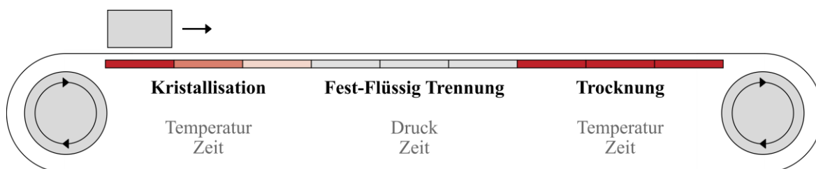
Abbildung 3.7: Apparative Umsetzung des Bandkristallisators. Die Basis der Anlage ist ein klassischer Taktbandfilter. Im Gegensatz zur konventionellen Bauweise sind die Vakuumschalen durch Funktionseinheiten ersetzt und räumlich voneinander abgegrenzte Sektoren auf dem Filtermedium verbaut.
