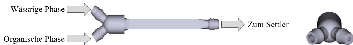
Abbildung 4.22: CAD-Ansicht des statischen Mischers. Um Rückvermischungen durch die unterschiedlichen Volumenströme der wässrigen und organischen Phase zu vermeiden, weisen die Zulauföffnungen verschiedene Durchmesser auf.
