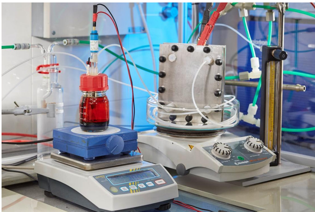
Abbildung 16: Foto des Teststandaufbaus [233] bestehend aus einer H_2/Br_2 -Einzelzelle (mittig), Wasserstoffdurchflussregler (rechts), und Bromelektrolyttank mit Hg/Hg_2SO_4/K_2SO_4(sat) -Referenzelektrode, und GC-Stab. Blick auf die Zelle in Richtung der Bromhalbzelle. Waschflasche zur Absorption von HBr und Br_2 im Hintergrund (links). Der Elektrolyttank ist auf einem Magnetrührer platziert, sodass bei der Verwendung von Salzschnmelze die Phasengrenzfläche zwischen wässriger Lösung und Salzschnmelze durch Rührbewegung erneuert wird. Gleichzeitig wird auf der Waage während Langzeitexperimenten die Massenänderung des Elektrolyten erfasst.
