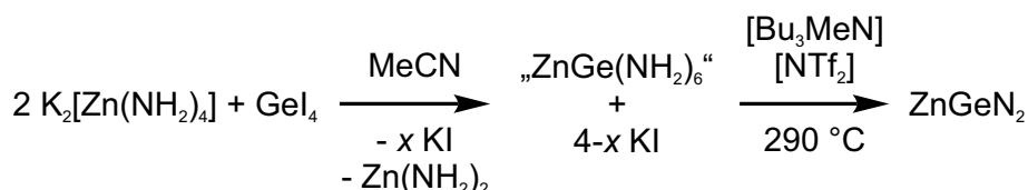
Abbildung 4.7: Syntheschema für ZnGeN 2 -Nanopartikel ausgehend von K 2 [Zn(NH 2 ) 4 ]. Um den Einfluss des KI-Gehalts der ZnGeN 2 -Vorstufe auf den Zinkgehalt der erhaltenen Partikel zu untersuchen, wurde die Vorstufe mit 15–60 mL Acetonitril gewaschen.
