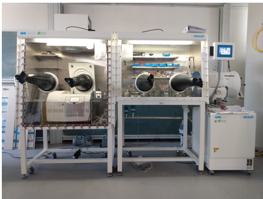
Abbildung 8.1: Aufbau eines doppelten Handschuhkastens mit integrierter Zentrifuge.
