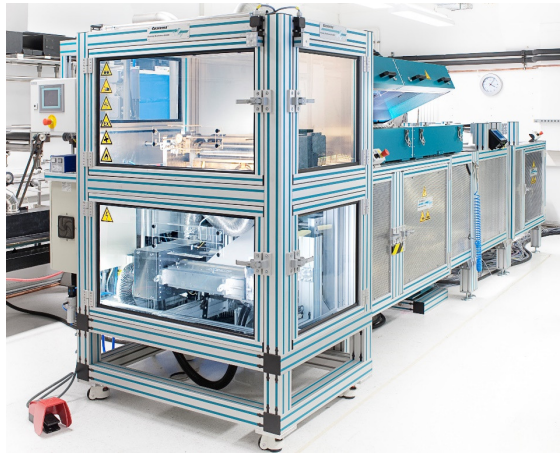
Abbildung 3.6: Rolle-zu-Rolle-Pilotanlage (BC43, Coatema Coating Machinery GmbH) zur Untersuchung von getrockneten Elektroden, unterschiedlichen Substraten und des Einflusses der Plasmabehandlung auf die Schlitzdüsenbeschichtung. Die verwendete Abbildung (Wengeler (2014)) ist unter CC-BY-SA 3.0 DE lizenziert ( https://doi.org/10.5445/KSP/1000039966 ) und als Ausschnitt nachgedruckt. [83]
