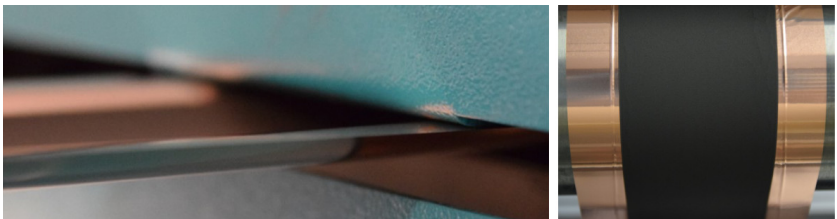
Abbildung 8.1: Schüsselungseffekt während der Trocknung (links) und dadurch entstandene Falten im Randbereich der Elektrodenbeschichtung (rechts).
