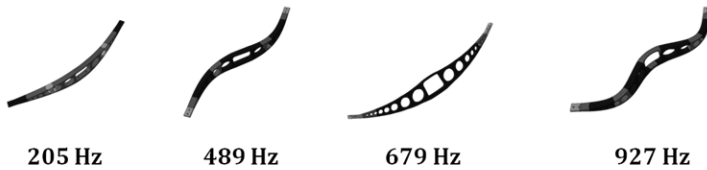
Abbildung 15: Eigenformen der Längsstrebe
