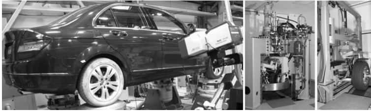
Abbildung 5: Untersuchung der Reifenschwingungen [Brä14]
