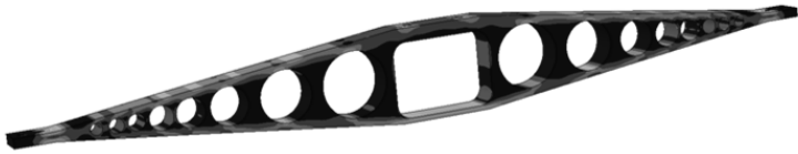
Abbildung 14: Qualitativer Spannungsverlauf der Längsstrebe des Radlastrahmens unter Biegebeanspruchung
