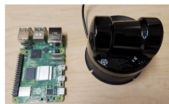
Abb. DEMO19-12: LiDAR Modul und Raspberry Pi
